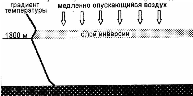
**Рис.176 Слой инверсии на высоте**
