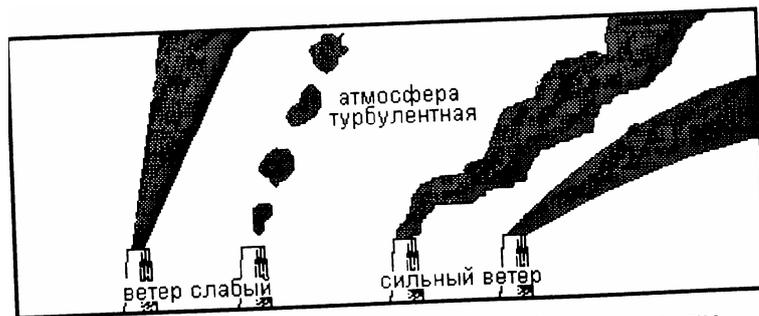
**Рис. 104 Дым как индикатор турбулентности**
