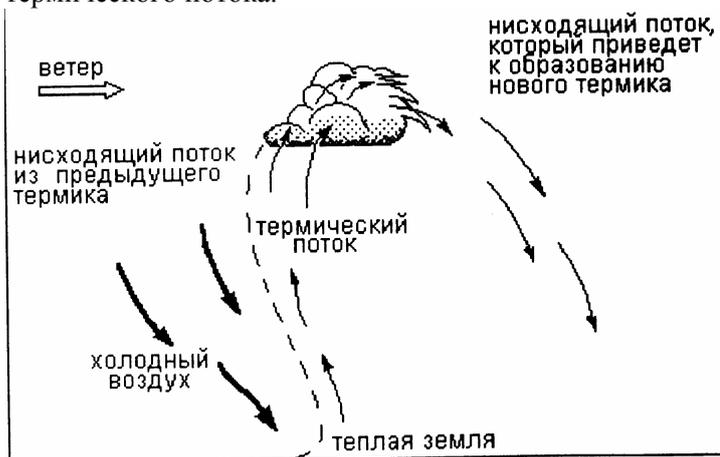
**Рис.206 Образование термиков в ветер**
